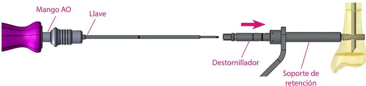
Valide visualmente que la ventana del tornillo Bullet esté abierta usando las marcas en los instrumentos.
