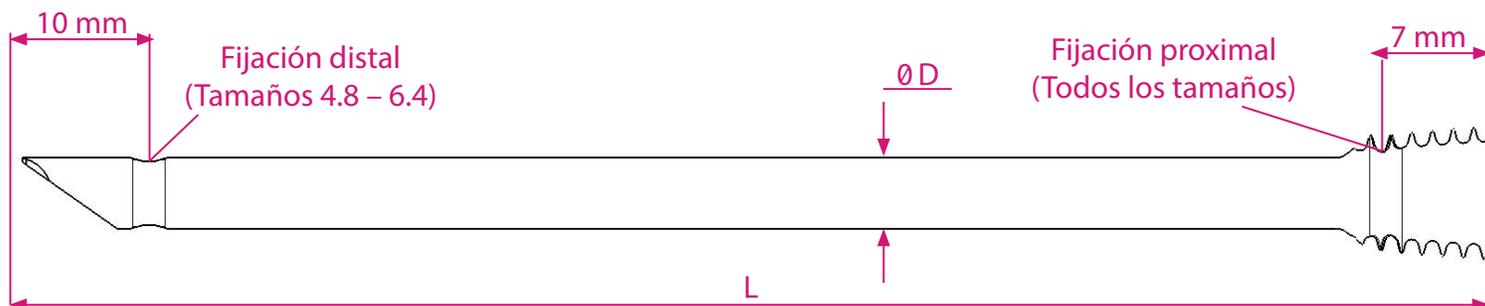
Seleccionar de la Tabla 1, Guía de selección del clavo SLIM, el SLIM que corresponda al diámetro y longitud deseados o seleccione un SLIM entero para corte personalizado (400 mm) del diámetro deseado. Véase la Tabla 2 (Paso 6) para las Opciones de Bloqueo.
